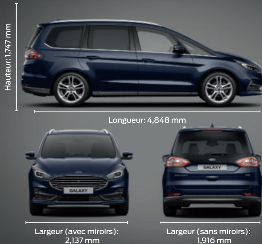
†Mesure conforme ISO 3832. Les dimensions peuvent varier en fonction du modèle et des équipements installés.
