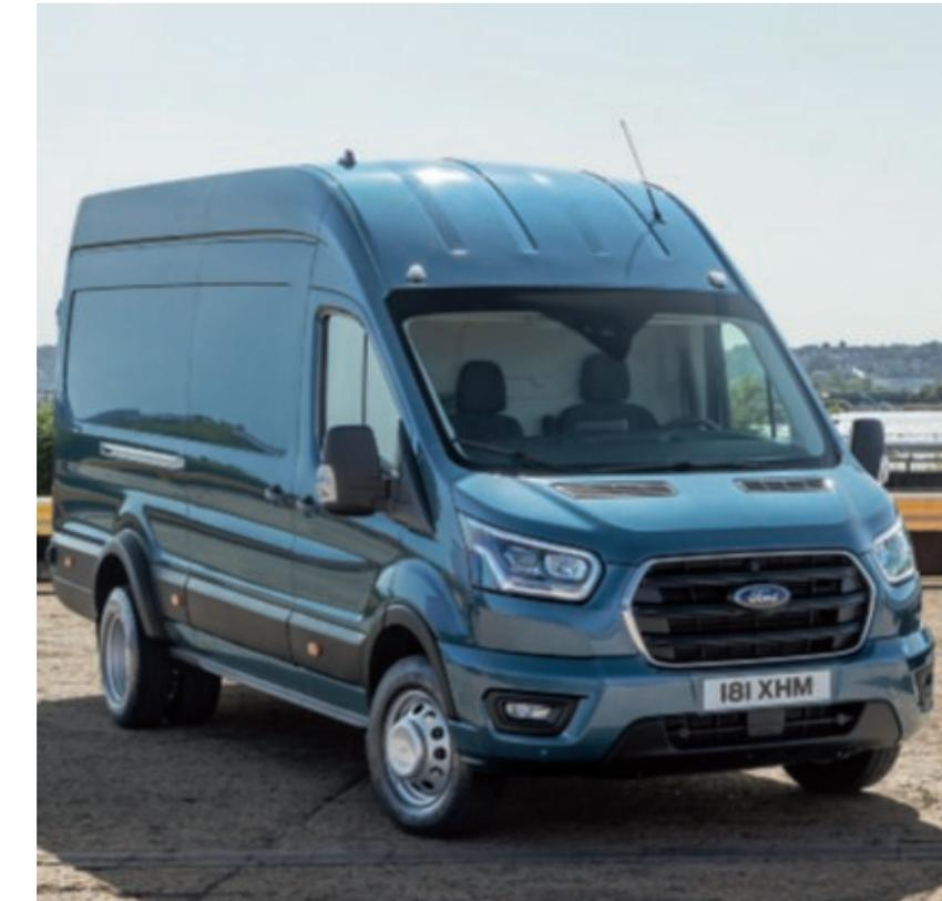
Les parois renforcées offrent une durabilité accrue en cas de tonnage supérieur, alors que les points d'arrimage, le marchepied intégré au pare-choc arrière et la longueur de chargement de 4,217 mm facilitent de transporter et charger des articles d'une longueur standard telle que les panneaux et les tuyaux.
