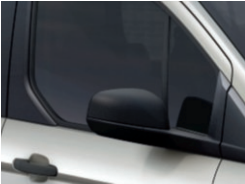
Rétroviseurs extérieurs chauffants à commande électrique (De série)
