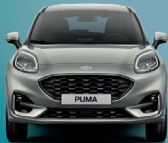
Largeur (avec rétroviseurs) : 1,930 mm
