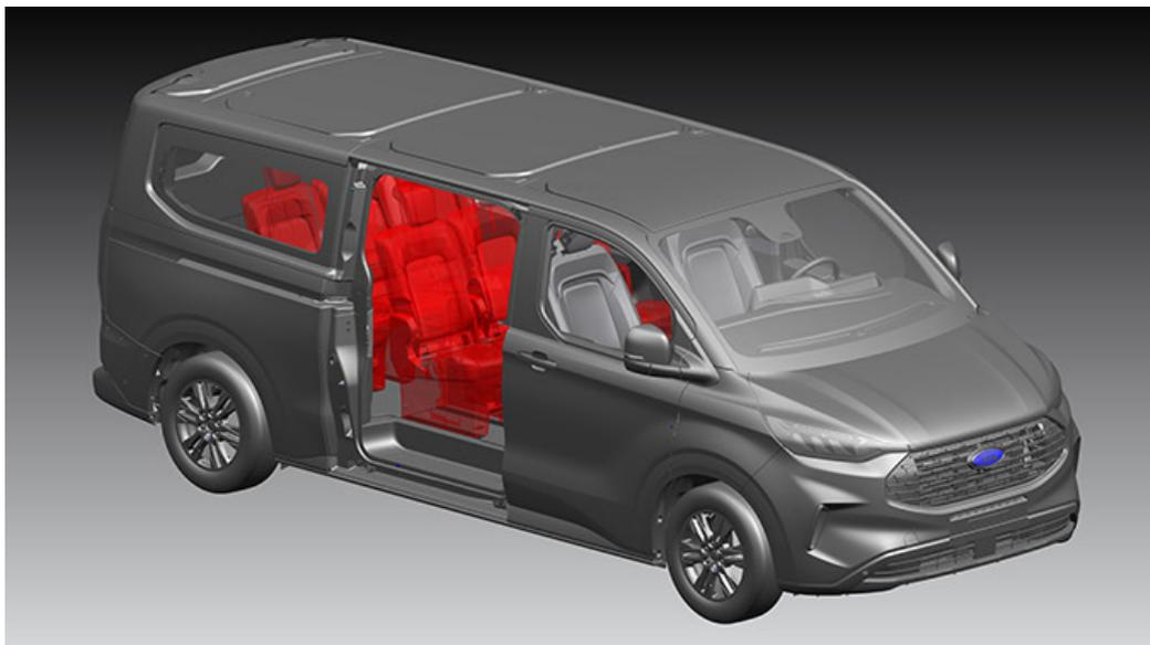
Le pack est conçu pour les conversions en taxis ou WAV où il est nécessaire de retirer les sièges des 2ème et 3ème rangées. Tous les sièges arrière sont retirés, ne laissant que le siège conducteur et passager avant. Le revêtement de plancher est également retiré à l'arrière du véhicule. Tournéo & Kombi uniquement (Véhicule incomplet - Multi-étapes)
