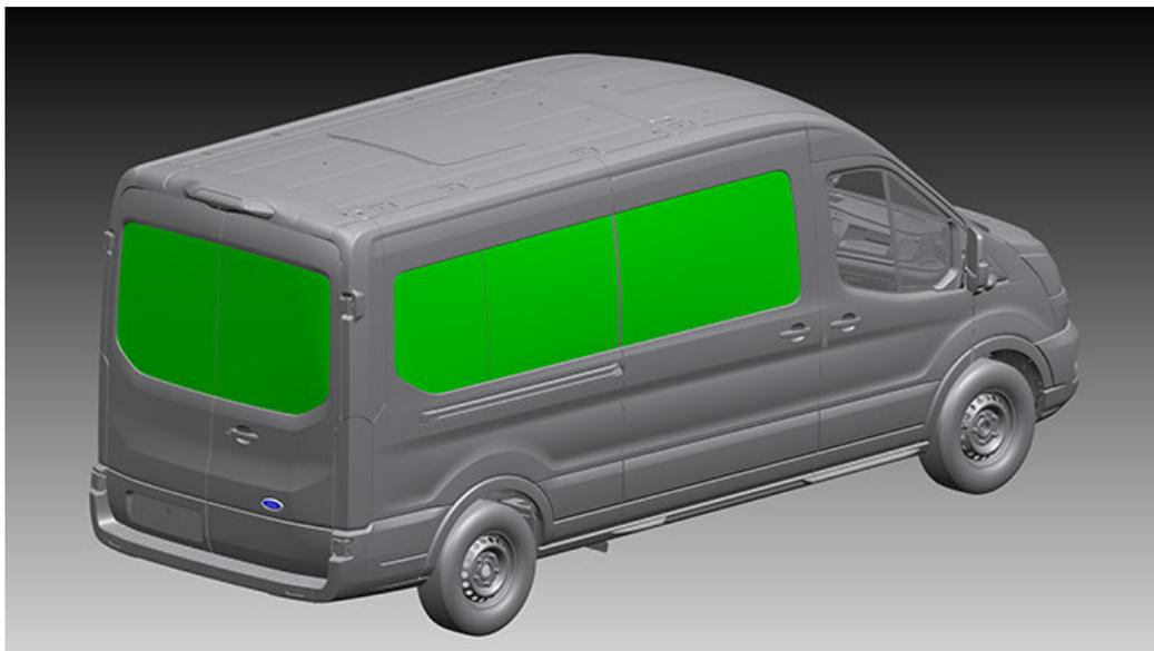
Cette option remplace les vitres teintées des portes de chargement arrière des véhicules donateurs de camping-car par des vitres d'intimité.
