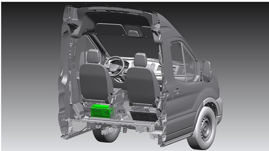
1 batterie AGM H8 de 95 Ah (~1,2 kWh) située dans le socle du siège conducteur.
