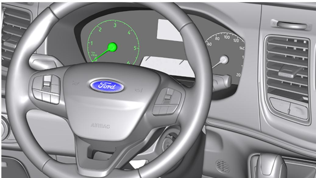
Le contrôleur de régime moteur permet de faire tourner le moteur à un régime élevé au ralenti. Cette option permet la montée en puissance électrique et mécanique nécessaire pour l'utilisation d'équipements supplémentaires.
