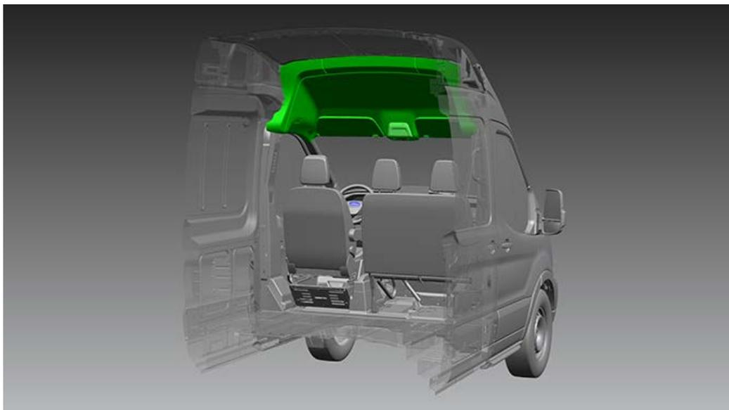
Cette option supprime la console de pavillon et la garniture de toit existantes avec fente DIN, en les remplaçant par une nouvelle garniture de toit plus haute sans étagère. Cela permet au conducteur de traverser vers l'arrière du véhicule puisque cela est uniquement possible sans la cloison.
