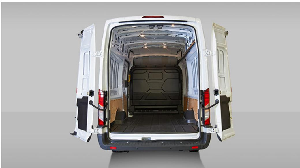
Permet de replier les portes de chargement arrière sur les côtés de la carrosserie, minimisant ainsi la largeur totale du véhicule lorsque les portes arrière sont ouvertes.
