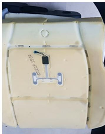
Le pack fournit les sièges pivotants de camping-car sans le tissu Ford, ce qui permet au convertisseur de les découper lors de la conversion. Pour protéger le témoin de ceinture de sécurité (dans le coussin du siège), le siège est recouvert d'un film protecteur.
