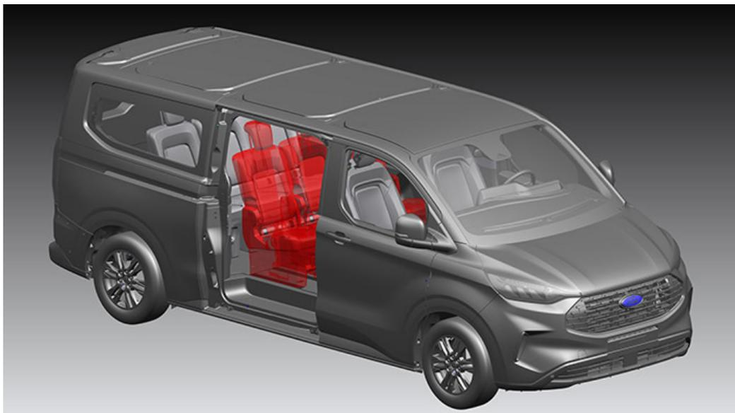
Le pack supprime les sièges de 2ème rangée et les dispositifs de retenue. Les sièges de la 3ème rangée se composent d'un siège double et d'un siège simple ; revêtement de plancher laissé en place. Adapté aux conversions de véhicules accessibles aux fauteuils roulants et taxis. Système HVAC (chauffage, ventilation et climatisation) à l'arrière, derrière le siège simple.
