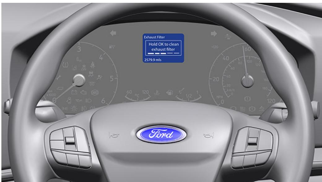
Cette option permet au conducteur de déclencher manuellement la régénération du FAP lorsque le véhicule est immobile avec le moteur tournant. Le processus prend entre 10 et 20 minutes. Lorsqu'un cycle de régénération est requis, un signal s'affiche sur le tableau de bord. Recommandé pour les véhicules diesel qui sont utilisés principalement pour des trajets courts ou des ralentis prolongés.
