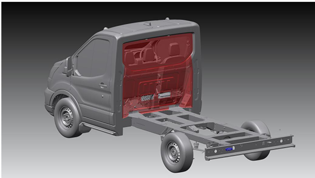
Véhicule donneur qui permet des conversions permettant de passer de la cabine à la zone de chargement
